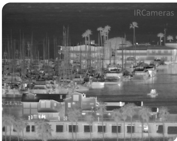
画像1: SupIR 28-850mm f/5.5 SXGA フォーマット連続ズームレンズで 3.6kmの距離から、IRカメラの赤外線イメージングシステムを介して撮影されたIRサーマルイメージング画像
